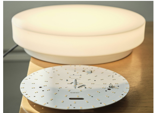
Integration der unsichtbaren SmartLink Sensorik in einen LED-Umbau Kit.
